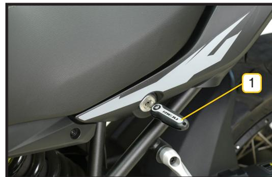
Levez la partie avant du siège du passager et poussez-le en avant pour le retirer.
